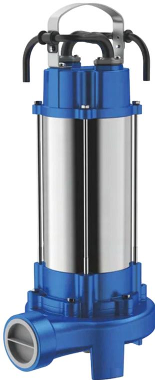
A motobomba submersível trituradora da HydroSystem é um equipamento ideal para drenagem de esgoto. A lamina de corte instalada na entrada da bomba facilita o corte dos sólidos em suspensão evitando o bloqueio do rotor, tornando a operação da motobomba estável mesmo em ambientes hostis.
