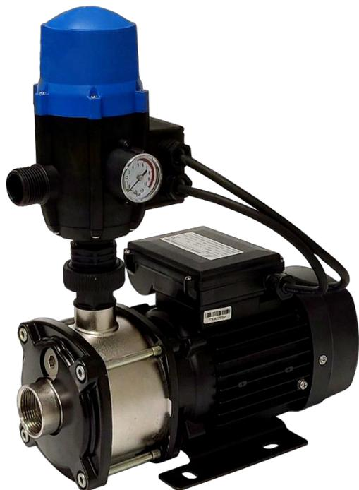
Os Sistemas de Pressurização **CA PLUS-H01** da **HydroSystem**, são compostos por uma única motobomba centrífuga multiestágio, com acionamento e controle automático realizado através de um controlador eletrônico de pressão, o qual liga e desliga a motobomba conforme a necessidade de consumo no sistema hidráulico. Indicado para diversas aplicações, os Sistemas de Pressurização **CA PLUS-H01**, podem ser utilizados em pressurizações de baixo para cima ou de cima para baixo.
