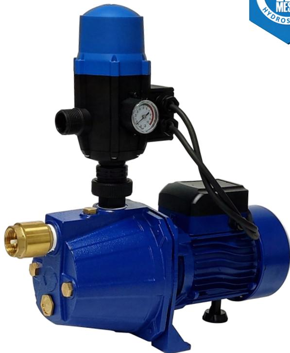
Os Sistemas de Pressurização **CA-Jm-H01** da **HydroSystem**, são compostos por uma única motobomba autoaspirante, com acionamento e controle automático realizado através de um controlador eletrônico de pressão, o qual liga e desliga a motobomba conforme a necessidade de consumo no sistema hidráulico. Indicado para diversas aplicações, os Sistemas de Pressurização **CA-Jm-H01** podem ser utilizados em pressurizações de baixo para cima ou de cima para baixo.
