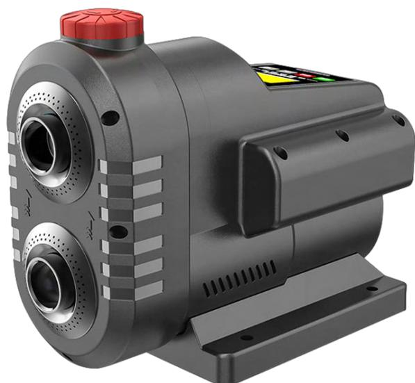
Os Sistemas de Pressurização **APF-204** da **HydroSystem**, são compostos por uma única motobomba centrífuga multiestágio, com acionamento e controle automático, realizado através de inversor de frequência incorporado ao equipamento, que varia a velocidade do motor conforme a demanda de água requisitada pelo sistema hidráulico, o que garante a regularidade da pressão, proporcionando conforto, qualidade e baixo consumo de energia.
