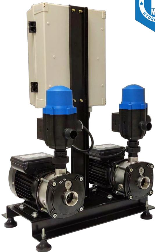
Os Sistemas de Pressurização **CA PLUS-H02** da **HydroSystem**, são compostos por duas motobombas centrífugas multiestágio, com acionamento e controle automático realizado através de um controlador eletrônico de pressão por motobomba, o qual liga e desliga as mesmas conforme a necessidade de consumo no sistema hidráulico. Indicado para diversas aplicações, os sistemas de Pressurização **CA PLUS-H02**, podem ser utilizados em pressurizações de baixo para cima ou de cima para baixo.
