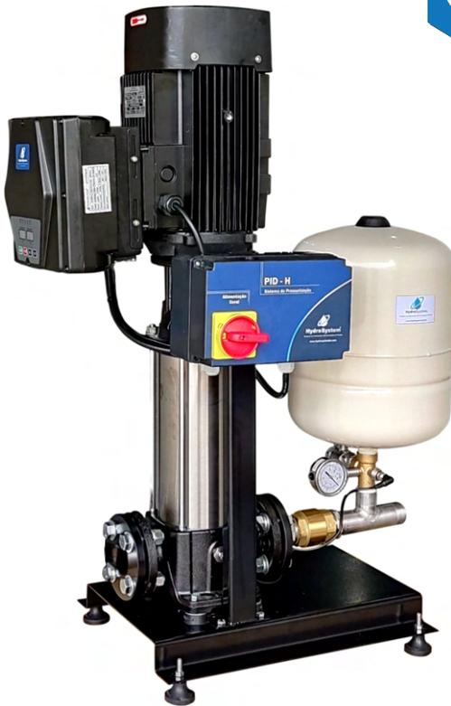
Os Sistemas de Pressurização **PID-V01** da **HydroSystem**, são compostos por uma única motobomba centrífuga multiestágio vertical, com acionamento e controle automático, realizado através de inversor de frequência, responsável pela variação da velocidade do equipamento conforme a demanda de água requisitada pelo sistema hidráulico, o que garante a regularidade da pressão, proporcionando conforto, qualidade e baixo consumo de energia.
