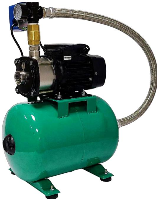
Os Sistemas de Pressurização **TP-H01** da **HydroSystem**, são compostos por uma única motobomba centrífuga multiestágio, com acionamento e controle automático realizado através de um pressostato mecânico, o qual liga e desliga a motobomba conforme o diferencial de pressão no sistema hidráulico. Indicado para diversas aplicações, os Sistemas de Pressurização **TP-H01**, podem ser utilizados em pressurizações de baixo para cima ou de cima para baixo.
