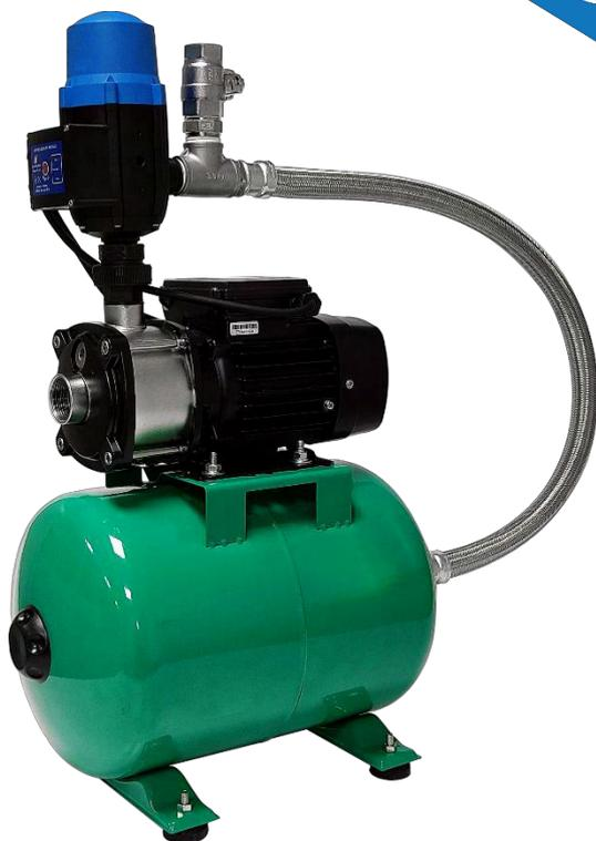
Os Sistemas de Pressurização **CA PLUS-V-H01** da **HydroSystem**, são compostos por uma única motobomba centrífuga multiestágio, com acionamento e controle automático realizado através de um controlador eletrônico de pressão, o qual liga e desliga a motobomba conforme a necessidade de consumo no sistema hidráulico. Os sistemas de pressurização **CA PLUS V-H01**, dispõem de um vaso de expansão, o qual auxilia na absorção das variações de pressão durante as partidas e paradas do equipamento.
